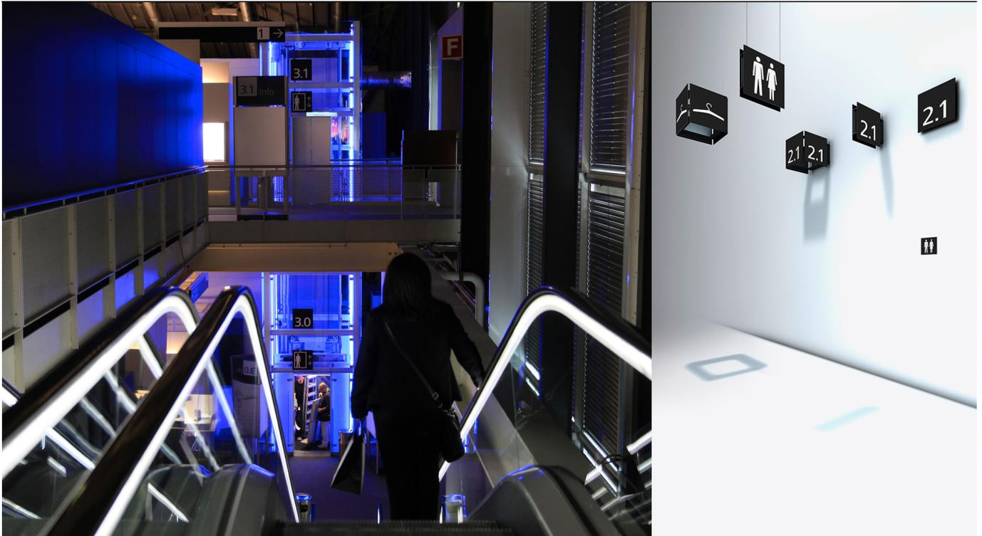
**Die Wand- und Stechschilder sowie die Deckenkuben dienen primär zur Kennzeichnung von öffentlichen Einrichtungen wie WC's, Garderoben, Wickel- und Sanitätsräumen. Alle Grafikträger können ohne Werkzeuge rasch gewechselt, eingehängt und gesichert werden. Die Wandkonstruktionen mit Bettladenverschluss sind einfach zu demontieren und wieder zu montieren.**
